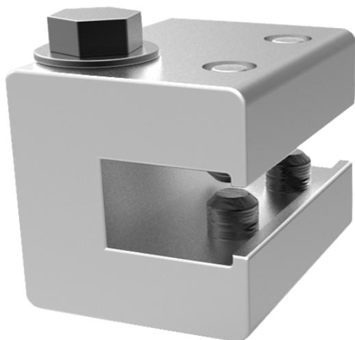
Grampa diseñada especialmente para crear un punto de anclaje en la cubierta seamer U45/ FAPYM modelos KR18/KR16/38/25. Permite hasta 2,16 KN (220 kg) con factor de seguridad 3 al arrancamiento y 5,23 KN (533 kg) con factor de seguridad 2 paralelo al seamer para chapa de espesores # 0,71.
